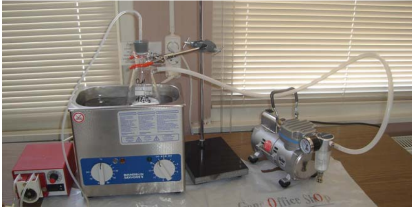
Resim 4.1. Katalizör sentezi deney düzeneği
